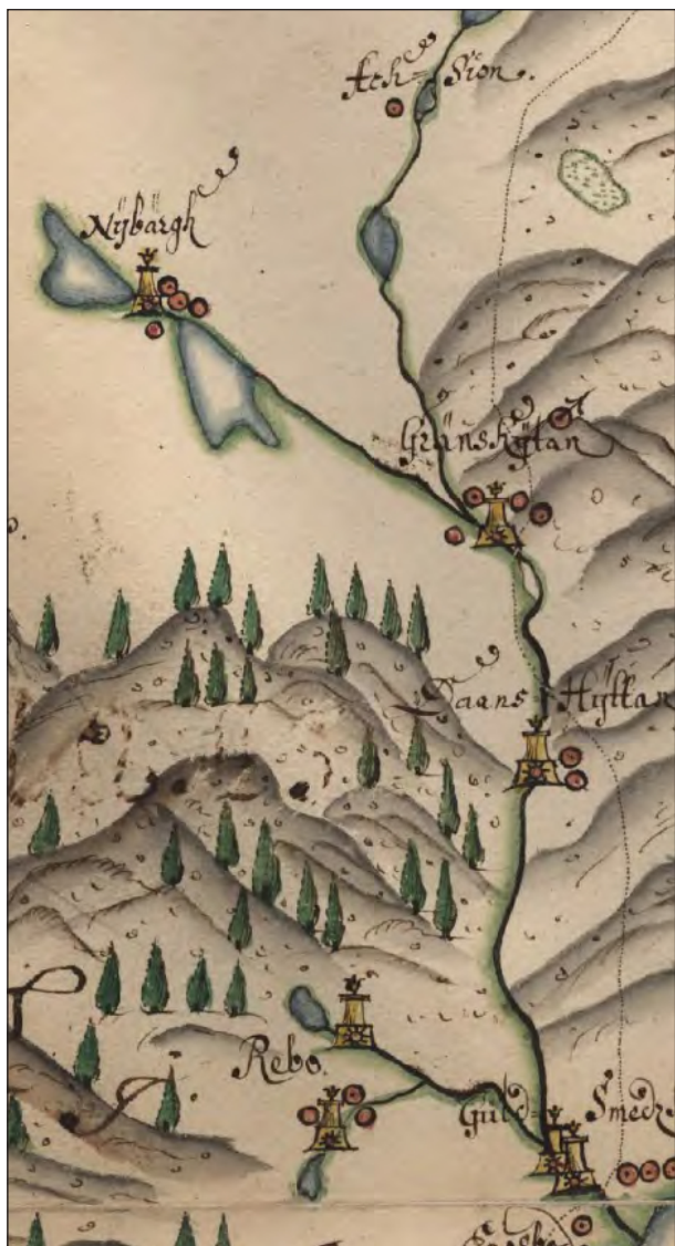
Figur 7. Ett pärlband av hyttor längs Hammar-skogsåns vattensystem såsom Nyberget, Gräns-hyttan, Danshyttan och Guldsmedshyttan. Medan Nyberget nyttjade Dammsjön nordväst om byn som dammsjö var de tre hyttorna nedströms beroende av Gränssjön som dammsjö (LMS 1688:S8:15).
