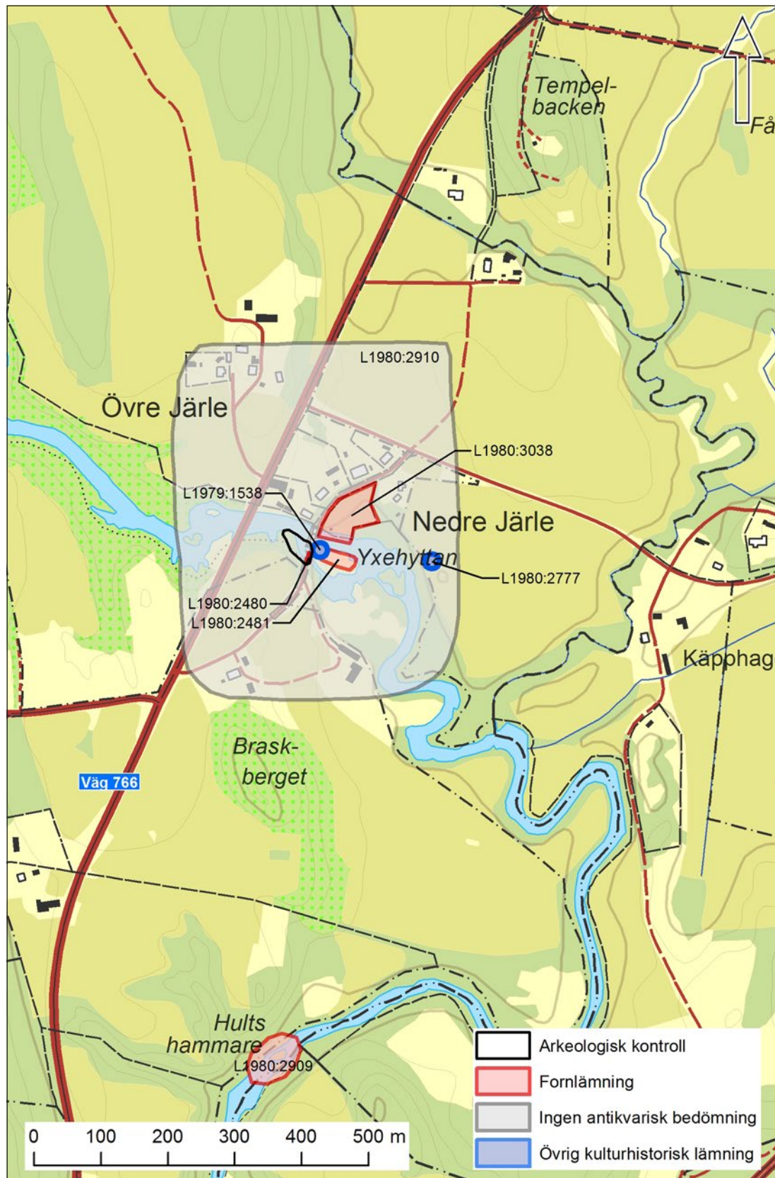
Figur 2. Området kring Järle utgörs av ett flertal industrilämningar i form av såg, kvarn, hytt- och hammarområde, vilka försetts med vatten av en gemensam dammanläggning. Skala 1:8 000.
