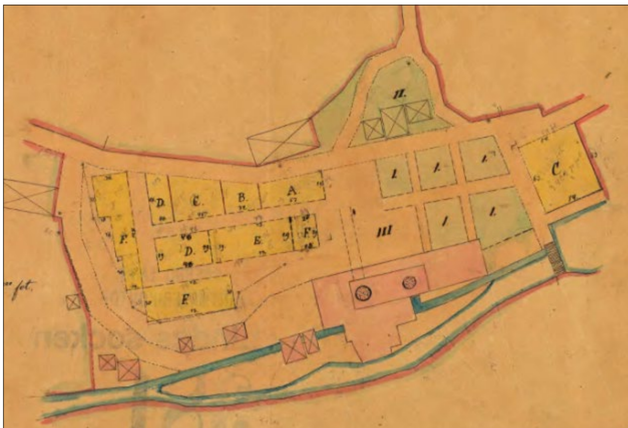
Figur 16. Delningskarta över Gusselhyttan år 1856 då sammanlagt sju hyttlag sammanslagits och bedrev sin tackjärnsproduktion vid Gusselhyttan. Enligt kartan löpte vatten in till hjulhuset via en ränna från dammbron, synlig till höger i kartan. Vattnet leddes därefter tillbaka ut i Albäcksån. Hyttbacken var uppdelad i tre delar: kol- och malmupplag samt en våg (LMA 1856:18-LIN-381).
