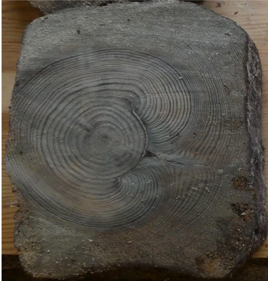
Tvärsnitt av stockprov 1. OBS övervallning av skada vid 6 år ålder.
