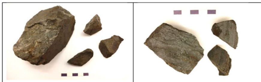
Figur 2. Prov 1 från A21, malmprov. Exempel på en större och några mindre bitar som är bland de tyngre och de med starkast magnetism. Bilden till höger visar delat tvärsnitt.
