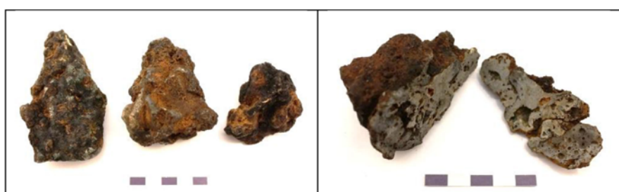
Figur 3. Prov 1 från A21, slagprov. Tre exempel på slaggar med finkornigt rött material som ytbeläggning. Bilden till höger visar tvärsnitt från den mittersta biten, med flera slagglöden.
