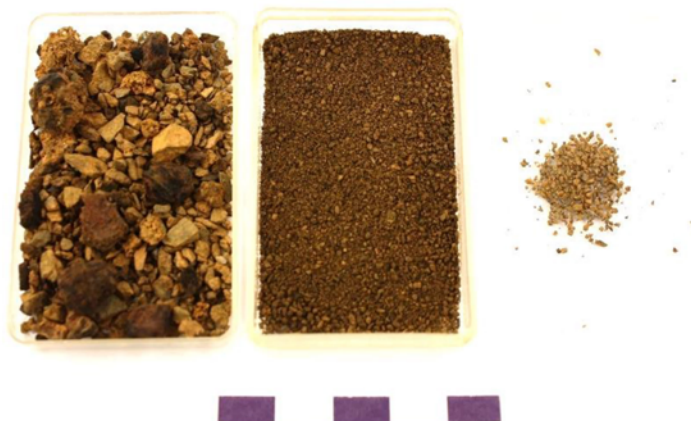
Figur 6. Prov 3 från A18. Provet är torkat och uppdelat i olika fraktioner, till vänster grövre och i mitten finkornigare material. Till höger det finkorniga materialet som det ser ut utan den extremt finkorniga ytbeläggningen.
