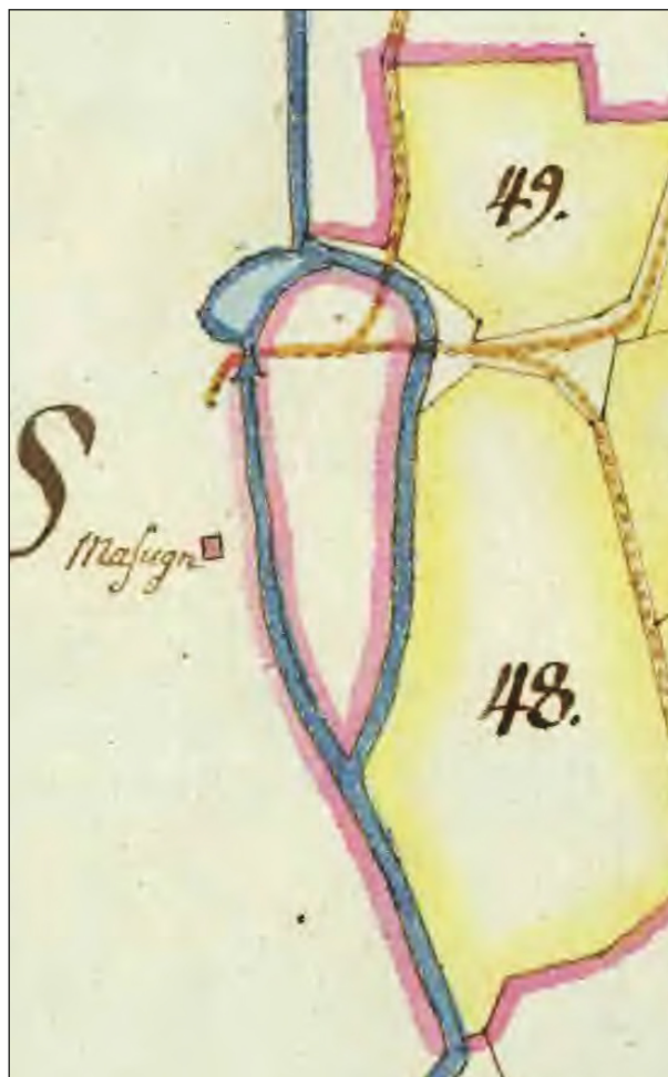
Figur 40. Karta från år 1788 då Torphyttans masugn ännu var i bruk. Vattendraget delar sig i två fåror varav den västra ledde till masugnen. Uppströms masugnen är en damm utritad. Dammen är numera utfylld och västra fåran torrlagd (LMS 1788:S46-66:2).
