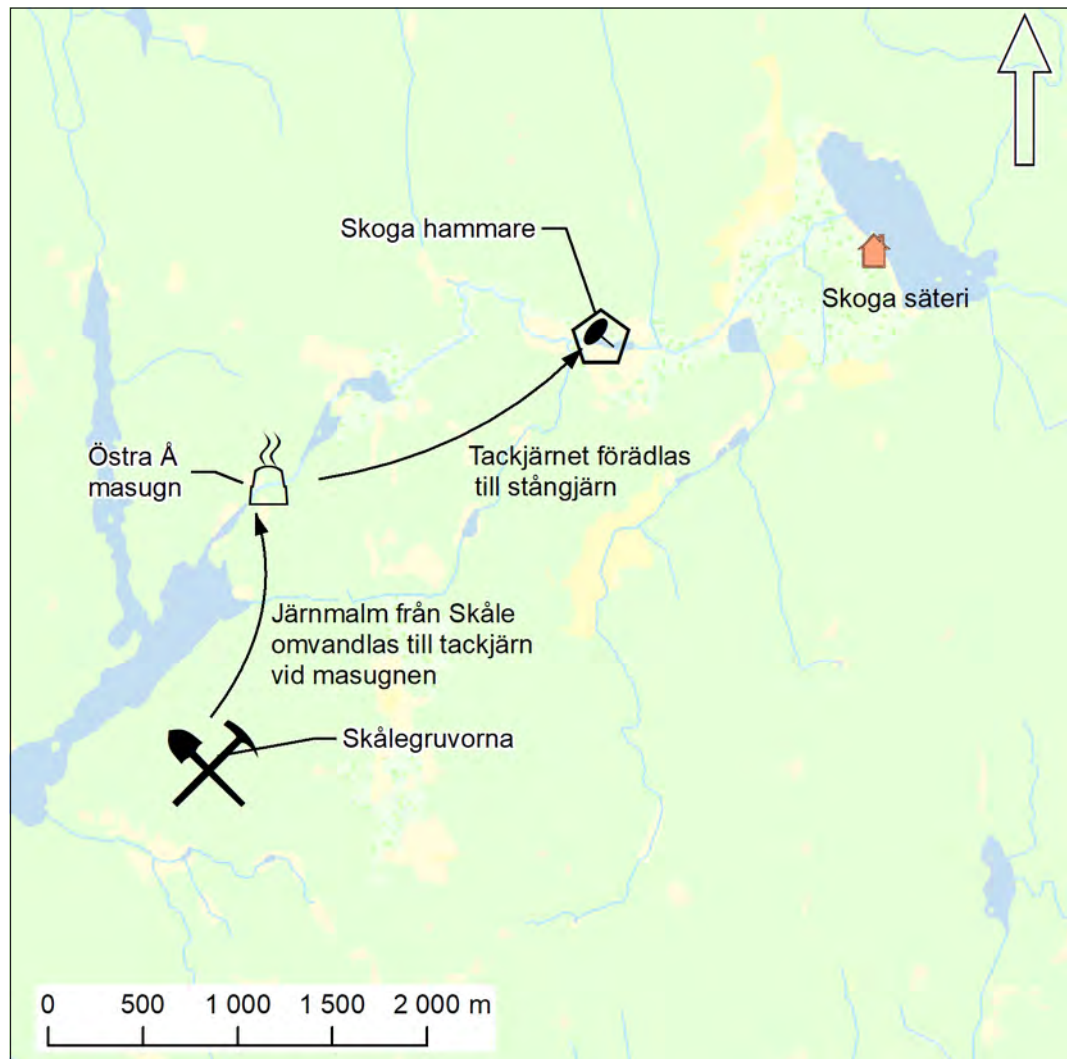
Figur 14. Järnhanteringsens steg, från gruva till stångjärn, inom Skoga gård under 1600-talet. Skala 1:40 000.
