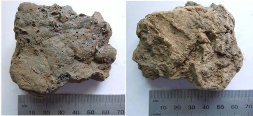
Fig. 18. Fragment med sekundärt sintrad/förglasad utsida och ett ca 1 cm brett pinnavtryck på motstående brottyta – 2 cm från utsidan (F1558, A1335).
