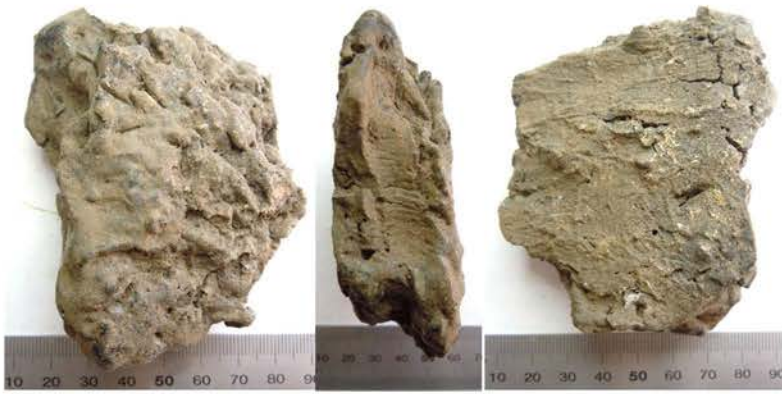
Fig. 7. Foton av sekundärt bränt fragment; från v: förglasad brottyta; pinnavtryck i kanten och sintrad, ursprunglig utsida (F1565, ugn
