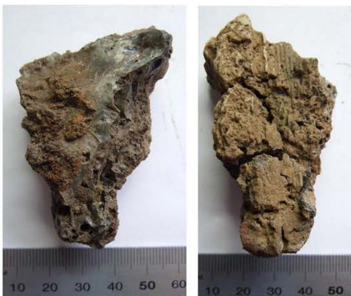
Fig. 15. Fragment med förglasad insida och motstående brottyta och plant avtryck av trästycke mindre än 2 cm från insidan (F1290, A1096).
