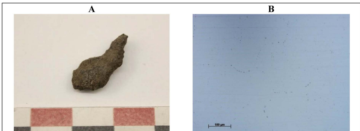
Figur 2D:5. A: Järnklump F3 från boplatsoområde L2021:368, bredvid järnframställningsplatsen L1981:158. B: Foto från mikroskopet på polerad yta, på det homogena ljusa metalliska järnet. Ett diffust mönster av små mörkare droppar antyder att det har stelnat från en smält, flytande, form, dvs. sannolikt inte i en blästugn.
