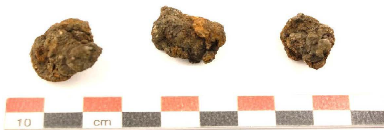
Fig. 20. Små magnetiska klumpar med metalliskt järn från ugnen A1430. De två till vänster är analyserade (prov A1430C1 och C2).
