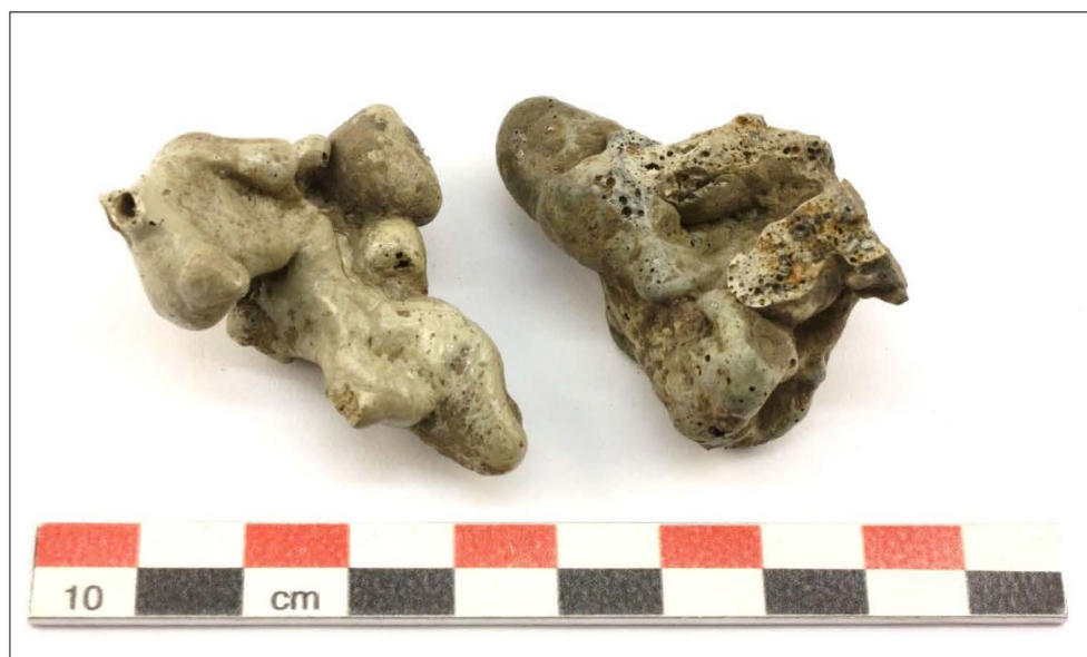
Figur 2C:15. A874. Två ljusa, stearinformade slagger. I brottytan på slaggen till höger ses ljusa fläckar som är osmälta mineral-korn (kvarter).
