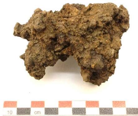
Fig. 18. Prov A1096C, en av de större magnetiska klumparna som innehåller metalliskt järn.
