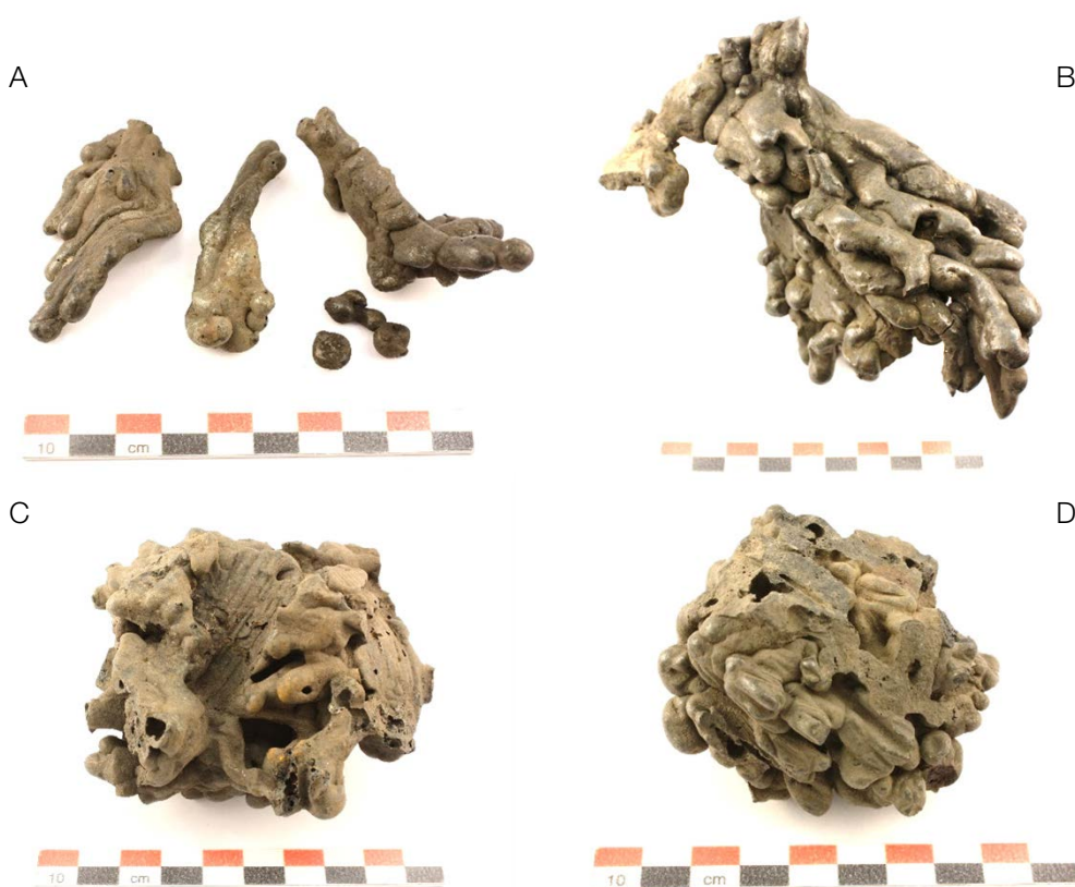
Fig. 10. Exempel på några av de karaktäristiska slaggformer som förekommer bland slaggerna från Fjugestas ugnar. A: från ugn A1392, små dropp- och stearinformade slaggsträngar. B: en slagg (från ugn A1392) där stearinformade slaggsträngar har format en större slagg. C: slagg (från ugn A1096) där stearinformade slaggsträngar har stelnat runt och formats av vedstycken. D: Slagg från ugn A847 där stearinformade slaggsträngar har avtryck efter tätt liggande parallella strån. Detta är tydligt även i A945 (se fig. 13).
