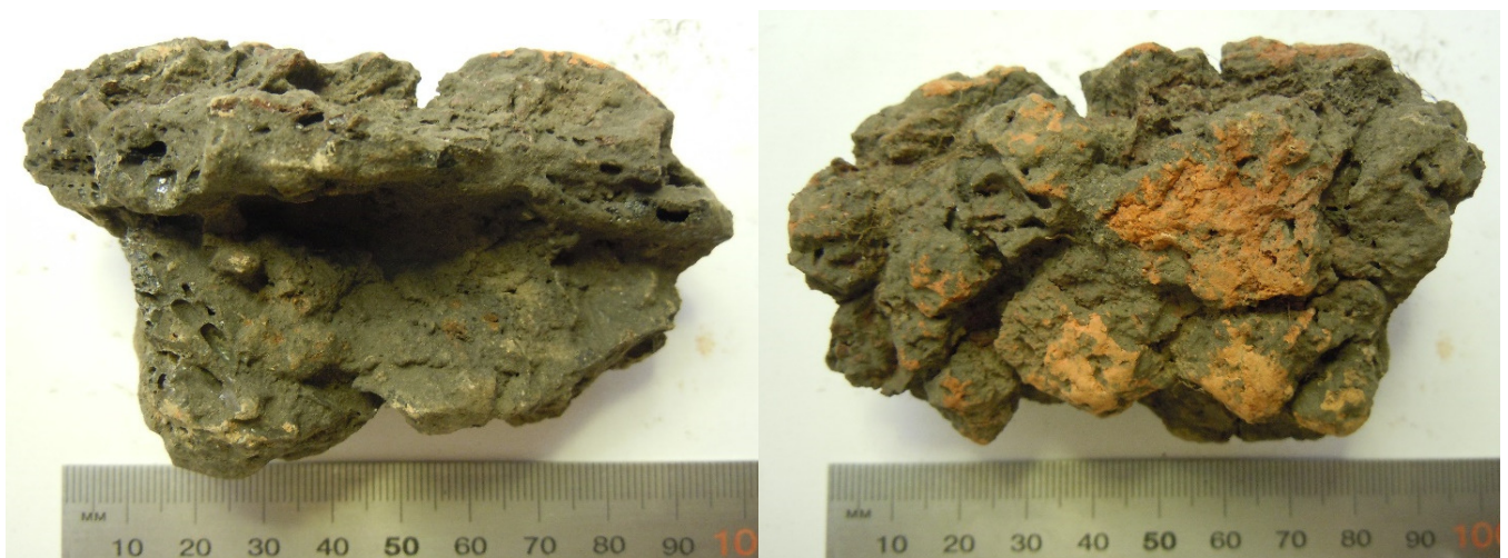
Fig. 1C:20. Större högbränd schaktrest från kolningsgropen A1446 (F1494). Från insidan tv till utsidan th ses en tydlig värmegradient. Stycket är också kraftigt vikt vilket kan betyda att det är en del av en lucka som öppnats för att ta ut luppen (jmf ugn A945).
