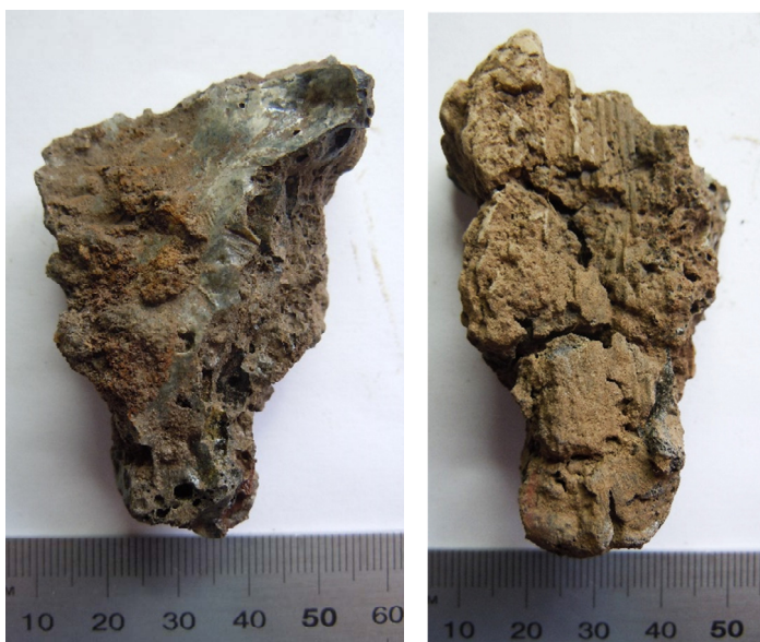
Fig. 1B:15. Fragment med förglasad insida och motstående brottyta och plant avtryck av trästycke mindre än 2 cm från insidan (F1290, A1096).
