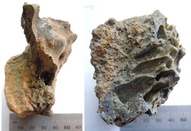
Fig. 1B:22. Tv fragment med bevarad in- och utsida (tjocklek 4-5 cm) och th mycket deformerat, förglasat fragment från schaktets insida (F1530, A1375).
