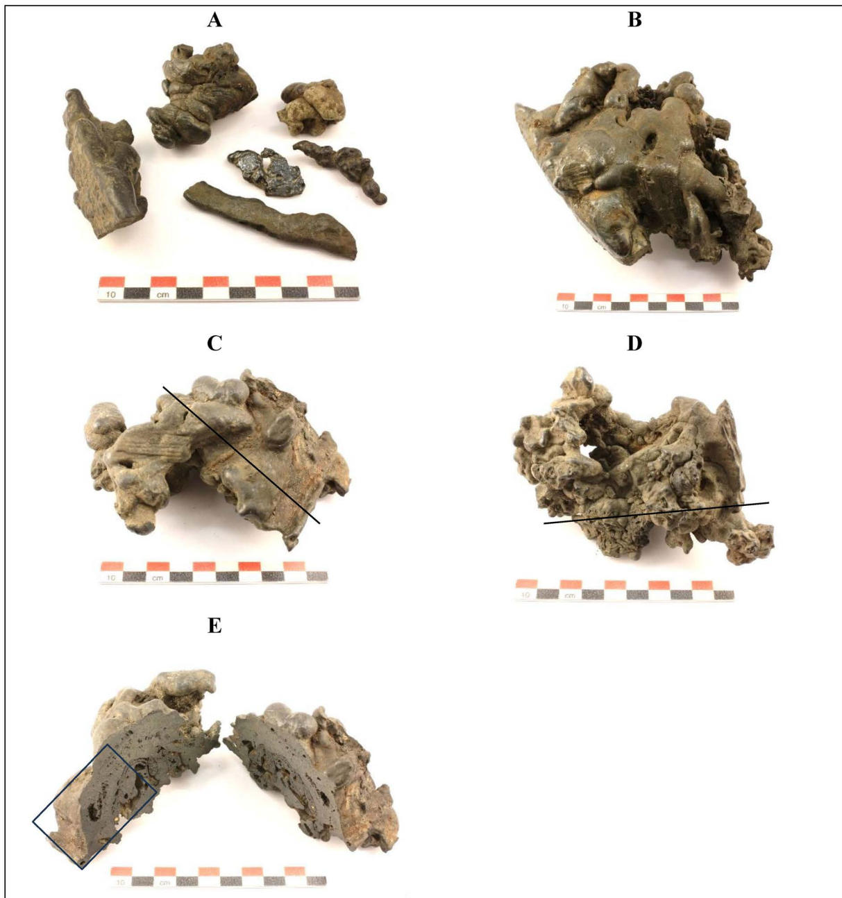
Figur 2C:5. Slaggar från ugn A970. A: Små stearinformade, tunna slaggar. B: slagg med rundat avtryck från gropväggen (till vänster). C och D: slagg (prov 970A) uppbyggd av flera slaggsträngar, C sedd ovanifrån, D underifrån där de tunna slaggsträngarna syns tydligt. E: slaggprov 970A delat (längs linjen i C och D) för analys (tunnslip från rutan).
