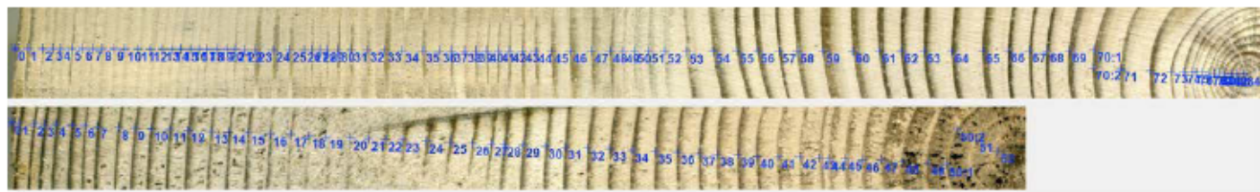
Prov P590 med 84 markerade årsringar överst. Därunder P594 med 52 markerade ringar.
