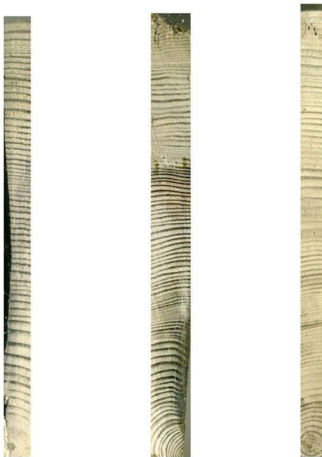
Prov nr 1 Prov nr 2 Prov nr 3 Skannade mätytor på provens lufttorkade och planslipade tvärsnitt.
